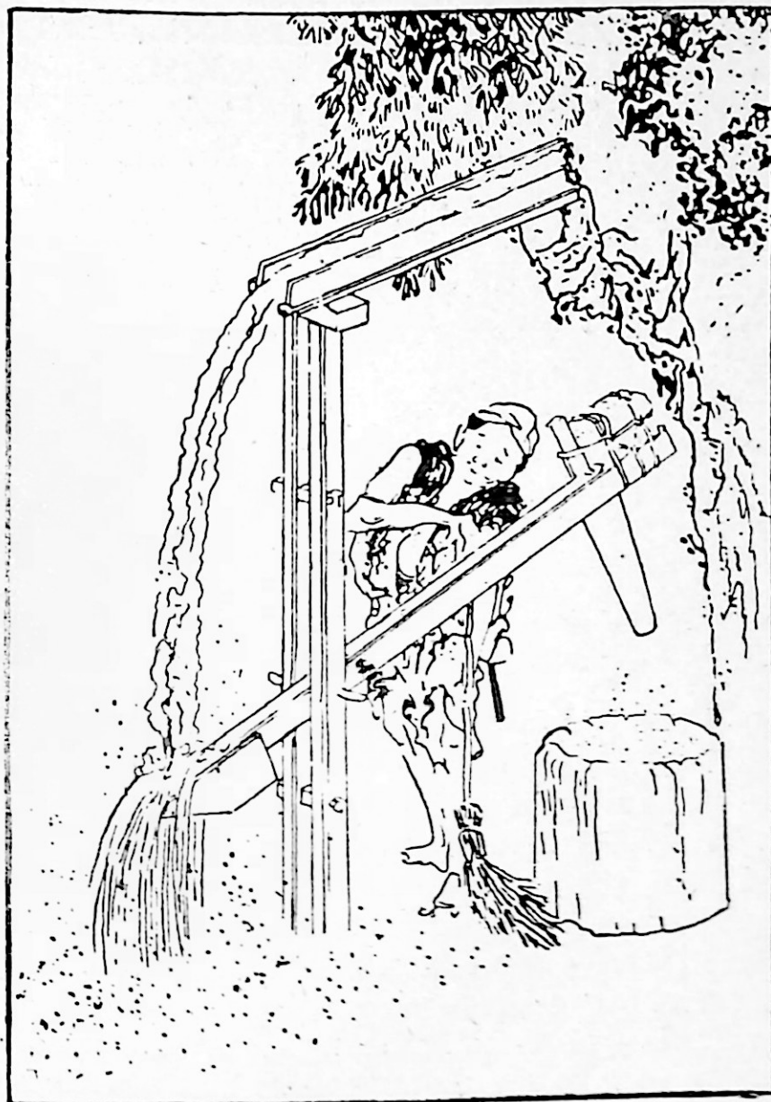
35. kép. Vízierővel hajtott kölyű Japánban. (H o k u s a i rajza nyomán.)
